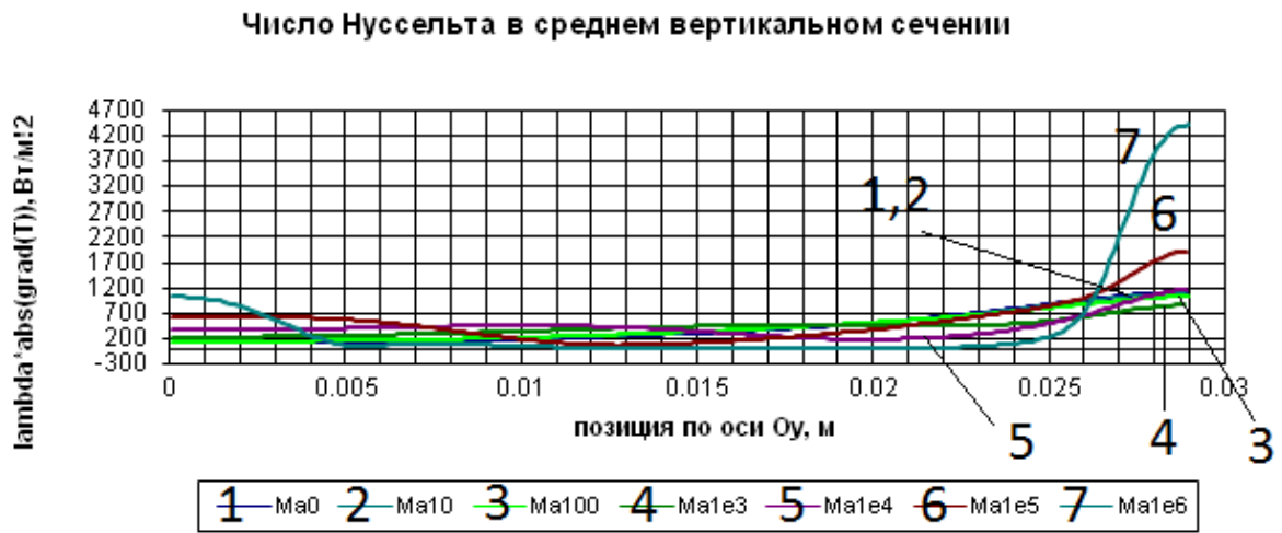
Рис. 4.18. Изменение числа Нуссельта \lambda \cdot \partial T / \partial y на вертикальной линии симметрии в зависимости от числа Марангони. Кристалл расположен при y=2.9 см.
