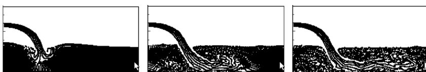
Рис. 4.6.12. Падение в водоем горизонтальной струи.
