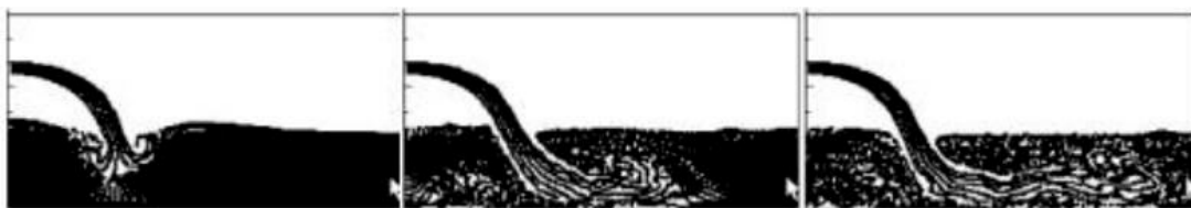
Рис. 4. Применение дискретных маркеров для расчета падения в водоем горизонтальной струи.
