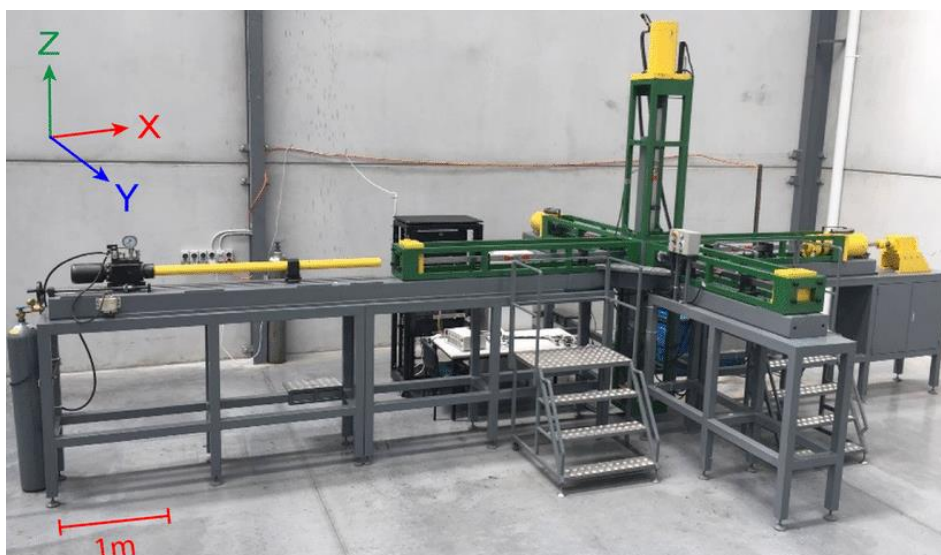
Рисунок 1.3 – Истинно трехосная установка, сконструированная в австралийском университете Монаша, для динамических (ударных) испытаний горных пород [130]
