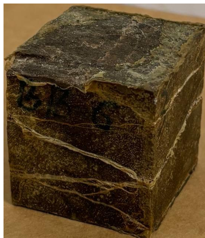
Рисунок 5.7 – Фотография образца ВВ6 после испытаний на ИСТНН
