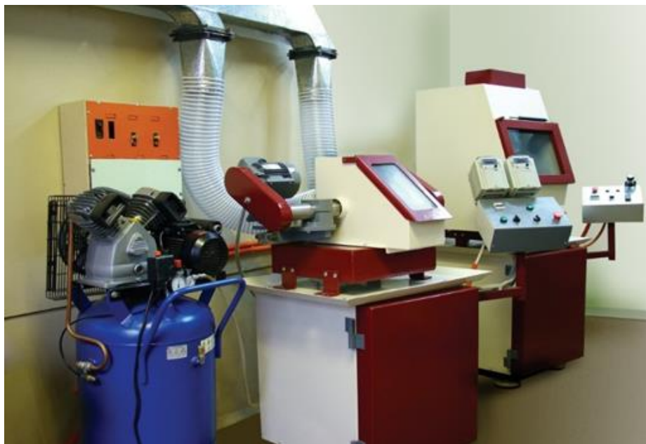
Рисунок 3.2 – Обрабатывающий комплекс для изготовления кубических образцов из керна материала
