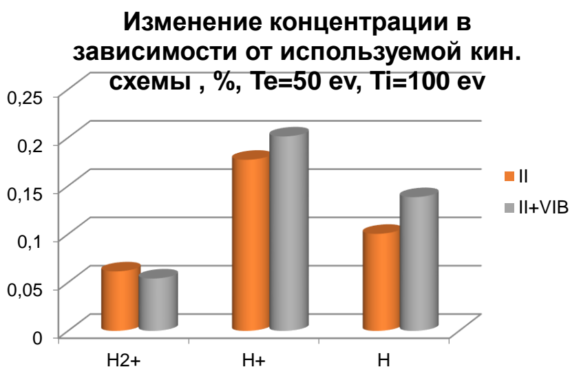
Рис. 29 Изменение концентрации в зависимости от используемой кин. схемы, %, T_e=50\text{ ev} , T_i=100 .
