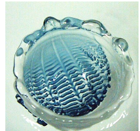
Регулярная структура течения растекания составной капли в воде (Изв. РАН. МЖГ, 2024)
